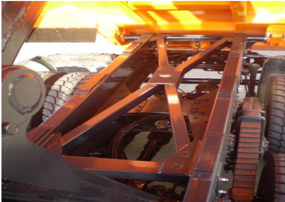
Refuerzo sobrebastidor con Cruz de San Andrés
