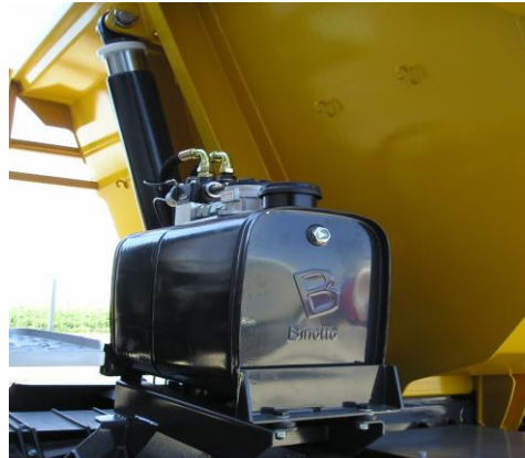
Detalle de depósito hidráulico
