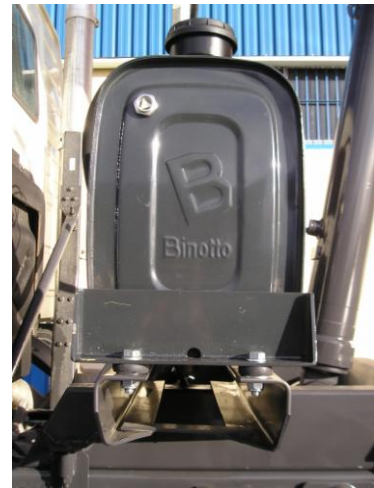
Detalle depósito aceite hidráulico
