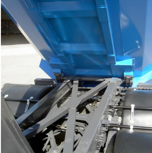
Refuerzo sobrestador con Cruz de San Andrés
