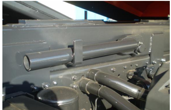
Tentemozo para operaciones de mantenimiento
