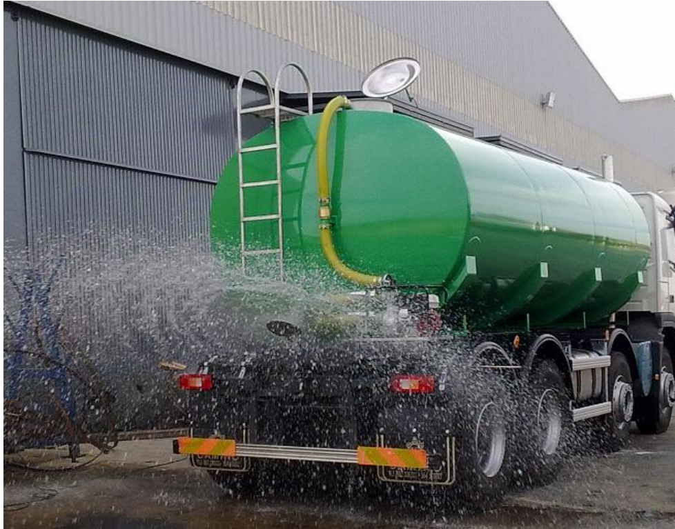
Sistema de riego en abanico con una amplitud de 6 a 8 metros con motobomba independiente
