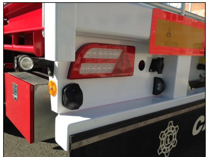
Detalle vista lateral piloto LED trasero
