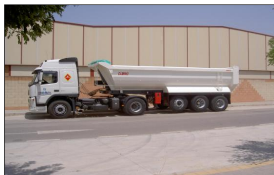
Vista lateral volquete 10 Ruedas 22 m 3
