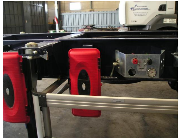
Detalle paraciclistas y caja portaextintor
